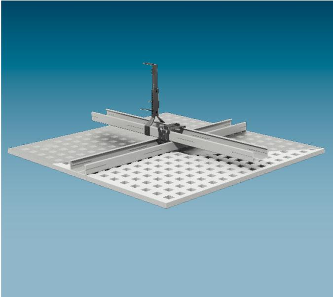
Knauf Cleaneo Akustikputzträgerplatten mit rückseitiger Folienkaschierung werden auf eine Metall-Unterkonstruktion aus Grund- und Tragprofilen (doppelter Profilrost) aus Stahlblechprofilen CD 60/27 geschraubt. Die Befestigung der CD-Profile erfolgt mit Abhängern an der Rohdecke. Auf den Tragprofilen kann eine akustisch wirksame Dämmschicht aufgelegt werden. Die abschließende Beschichtung erfolgt mit fumi Akustikputz S1 oder KRAFT Akustikputz Picco S.
